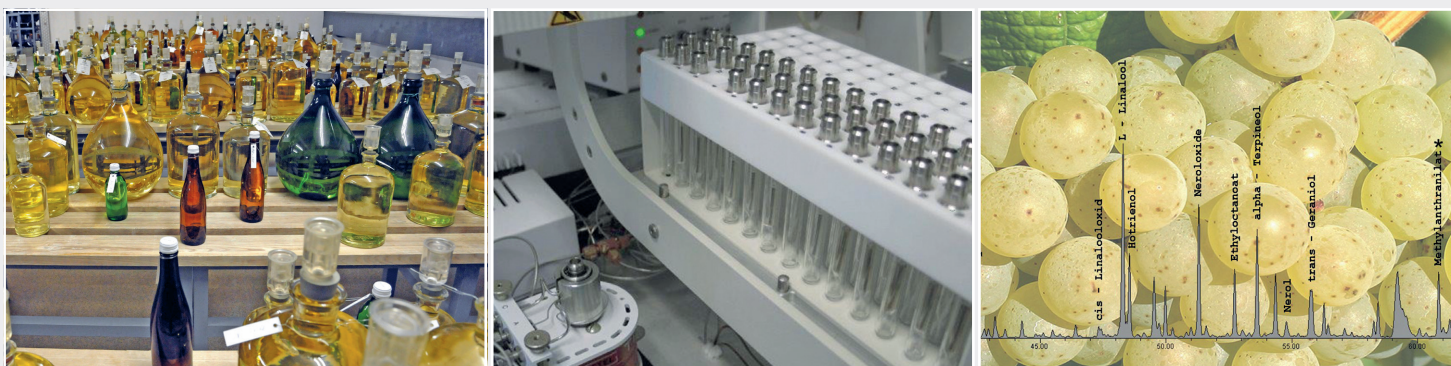
Abb. 6: Qualitätskontrolle an Most und Wein: I. Wein der Mikrovinifikation (Kleinmaßstab 1 – 100 Liter), Mi. Proben in der Gaschromatographie, r. Aromastoffprofil im Traubenmost zur Früherkennung des unerwünschten Methylanthranilats (* = Walderdbeeraroma) im Most, das zu einem Ausschluss des Rebstockes führt. Fig. 6: Quality control in must and wine: L. wine in microvinification (scale 1 – 100 Liter), mid. gaschromatographic samples, R. aroma profile of grape must showing the undesired methylanthranilate (* = wild strawberry flavor) resulting in the early removal of the plant from further evaluation.
