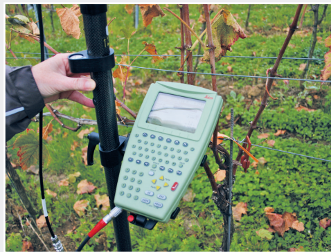
Einmessung von Kontrollpunkten mit GPS im Weinberg Measurement of control points with GPS in a vineyard
