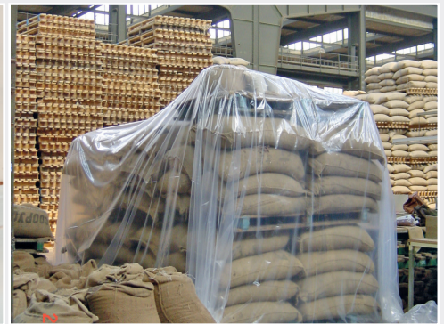
Zur Begasung abgeplanter Sackstapel von Vorräten Bag stack of stored products sealed for fumigation
