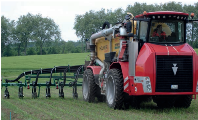
Scheibenschlitzgerät für die Gülleausbringung zwischen den Reihen
